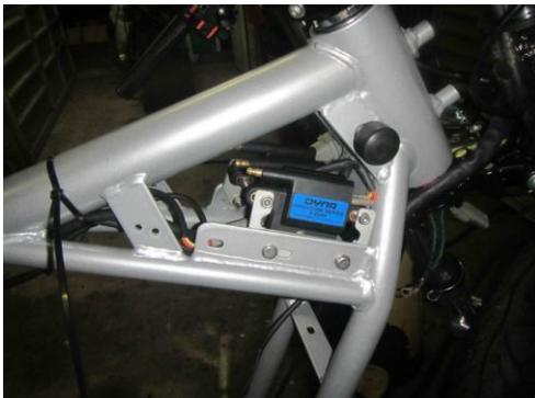
Cette photo montre une moto initialement équipée d'un BTZ avec des bobines Dyna Mini.
