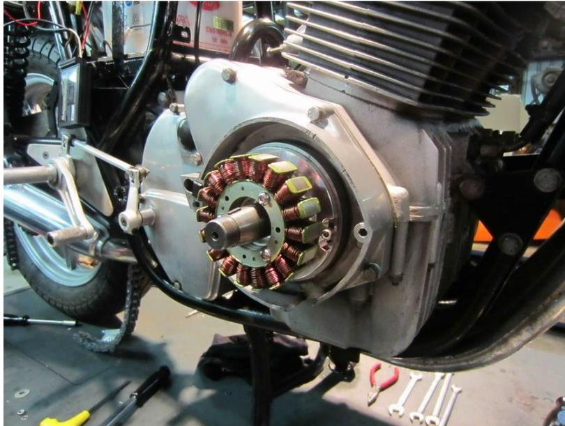
14- Installez le stator d'alternateur en le fixant avec les vis fournies, après avoir correctement positionné les câbles dans le pontet et en vérifiant que ces câbles ne sont ni pincés ni tordus.
