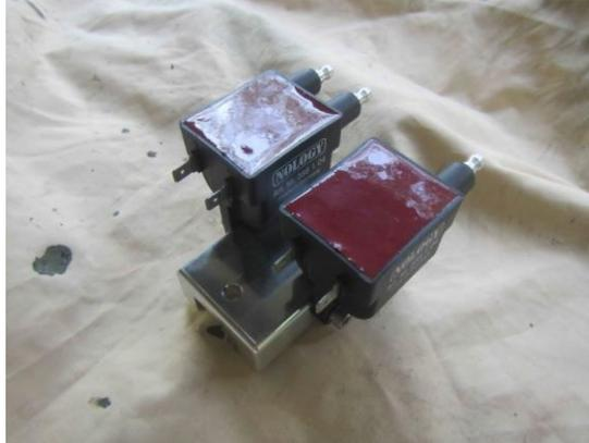
Sur cette photo, on voit des Nology Pro-Fire fixées sur un support Redax Engineering. Ce sont des bobines excellentes du fait de leur puissance (45000 V) et de leur petite taille permettant de les loger facilement près de la colonne de direction.
