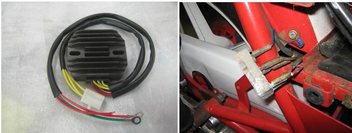
8- Déposer le redresseur d'origine qui est monté près de la batterie (photo ci-dessus à droite).
