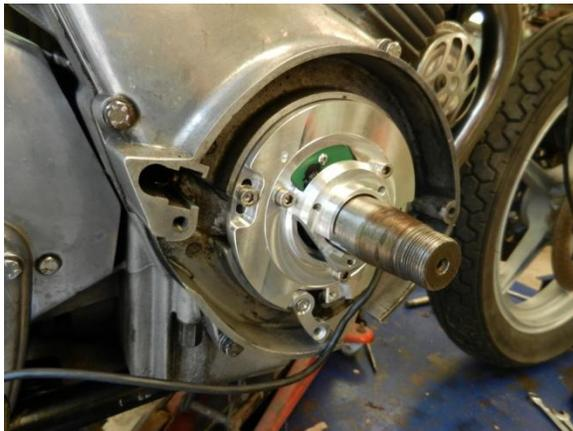
Maintenant le moteur est prêt à être démarré. Le mettre en route et le faire tourner quelques instants pour vérifier que tout va bien, puis l'arrêter et continuer avec l'installation de l'alternateur.
