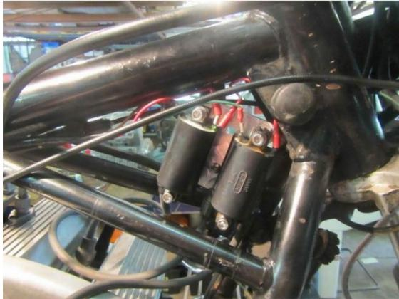
La photo ci-dessus montre des bobines TEK. Les câbles HT d'origine peuvent être réutilisés mais des câbles neufs (âme métallique, pas graphite!) sont préférables.
