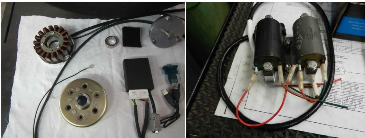
Sur la photo ci-dessus, le fils simple noir avec une cosse ronde est le fil de masse du système d'allumage, le brancher sur une bonne masse ou au moins batterie directement
