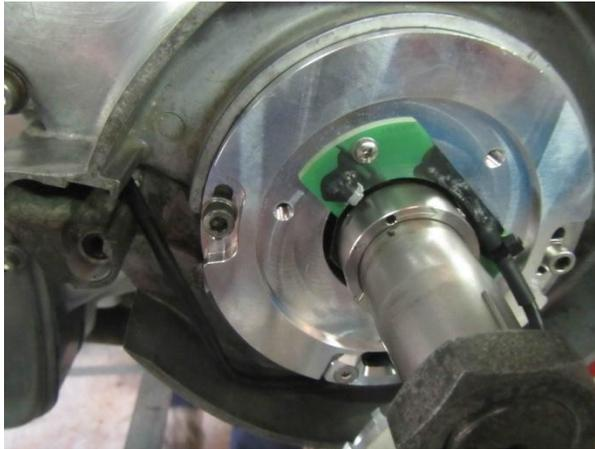
Remettre temporairement l'écrou de queue de vilebrequin en place (photo), cela permettra de faire tourner le vilebrequin pour les réglages.
