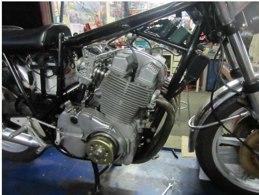
Revérifiez avec soin que les câbles ne peuvent pas être touchés par le volant d'alternateur, il seraient alors immédiatement endommagés.
