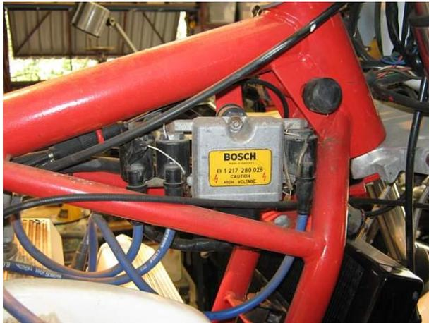
Les motos équipées du premier système HKZ doivent recevoir des nouvelles bobines, à placer près de la colonne de direction.
