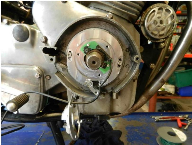
**NB:** Avant de glisser le faisceau dans le trou du carter d'alternateur, attention à d'abord le glisser dans la fente du nouveau plateau exactement comme sur la photo ci-dessus, dans le bon sens. Pour le moment laisser pendre la petite patte de blocage du faisceau comme sur la photo.
